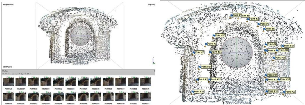
Figura 9 – Nuvola ‘sparsa’ da allineamento delle foto e nuvola con i marker assegnati.
