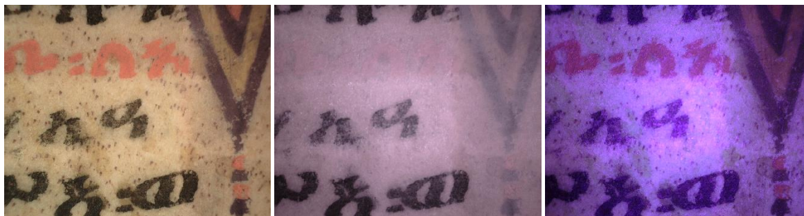
Fig. 29 - Particolare del testo di scrittura esaminato con microscopio Dino-Lite nello spettro del visibile (a sinistra), dell'infrarosso (al centro) e dell'ultravioletto (a destra).
