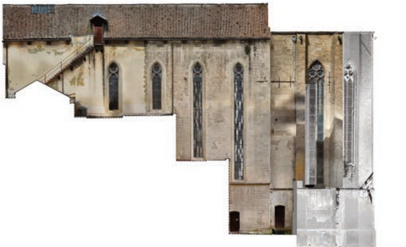
18. Prospetto lungo vico Donnaregina della chiesa di s. Maria di Donnaregina realizzato mediante fotomodellazione (integrazioni in grigio delle parti non fotografabili ottenute mediante ortoproiezione della nuvola dei punti elaborata da scanner laser)
