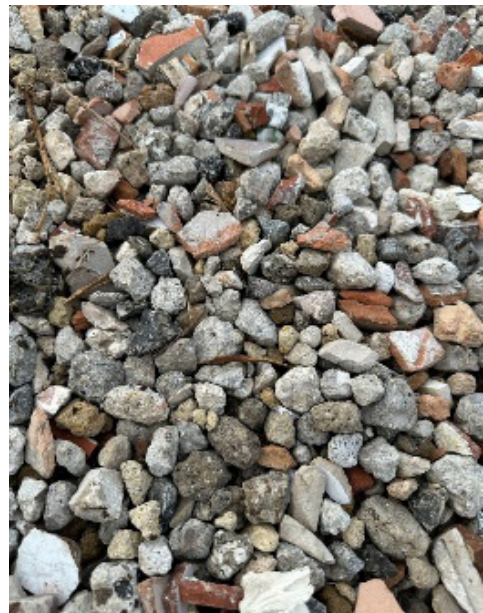
Figura 10. Malta per massetti/blocchi: aggregati riciclati.
