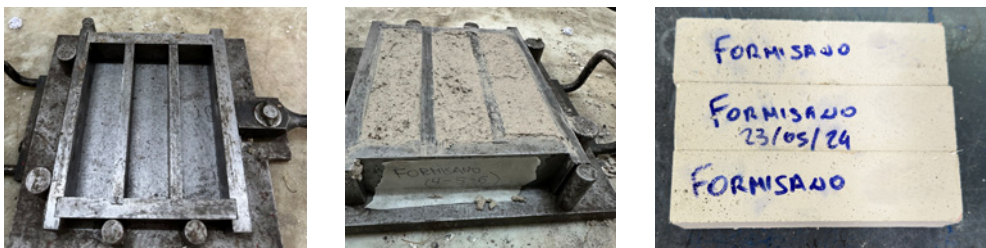
Figura 5. Confezionamento dei provini 40 \times 40 \times 160 mm.
