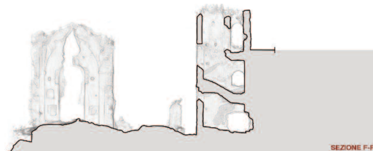
Fig. 13. Tavola IX - in alto, ortoproiezione da modello texturizzato del fronte principale di ingresso dell'antico complesso abbaziale con, in basso, proiezione della sezione A-A' che descrive lo sviluppo altimetrico della torre.
