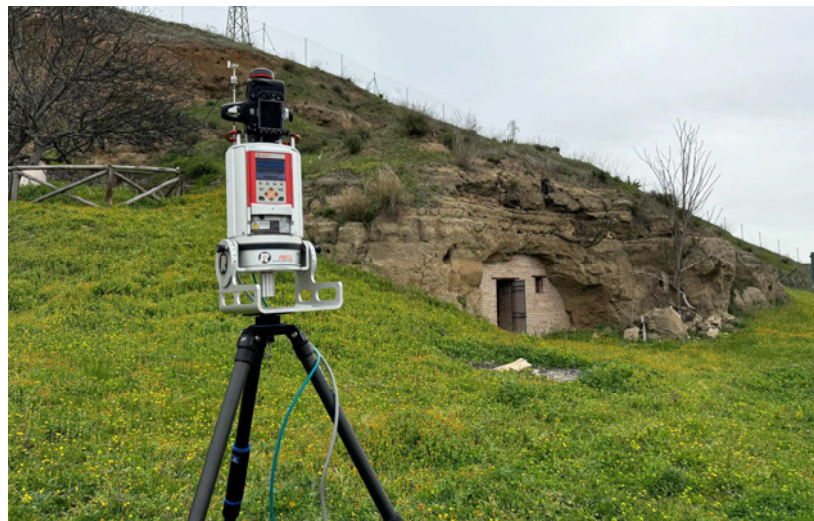
Fig. 3. Acquisizioni con lo scanner laser a tempo di volo Riegl VZ400.
