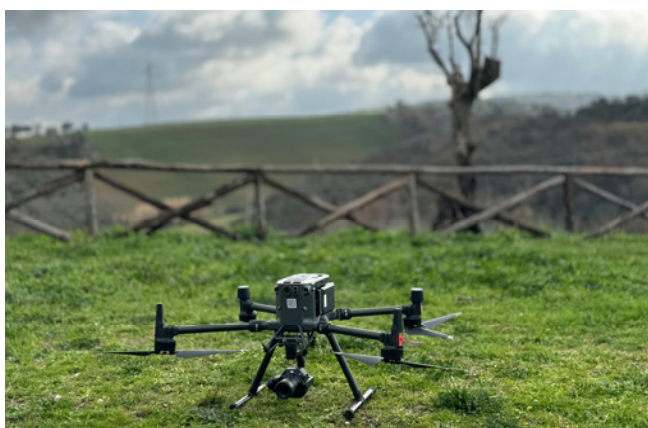
Fig. 2. Il drone DJI Matrice 300 RTK equipaggiato con camera Zenmuse P1.
