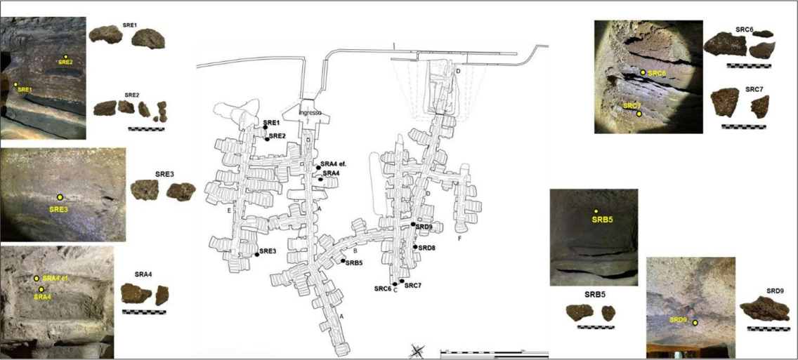
Fig. 3. Planimetria delle catacombe inferiori con posizione dei campioni prelevati (modificata da Lacerenza et al. 2020), immagini dei punti di campionamento e dei campioni.
