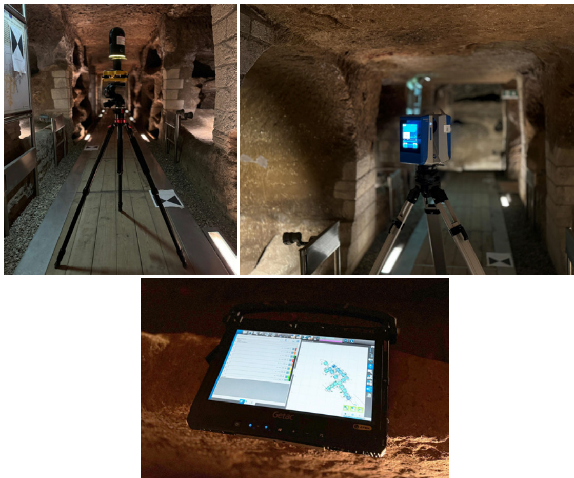
Fig. 5 (in alto a sinistra). Acquisizioni degli interni con lo scanner laser Leica BLK360.
