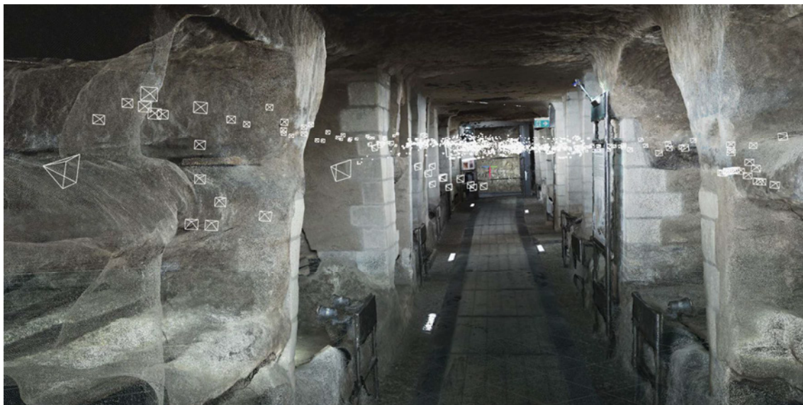
Fig. 11. Nuvola di punti dell'interno delle catacombe. Gli algoritmi di RealityCapture, riconoscendo la posizione della camera al momento dell'acquisizione, posizionano il fotogramma nello spazio elaborando il modello 3D.
