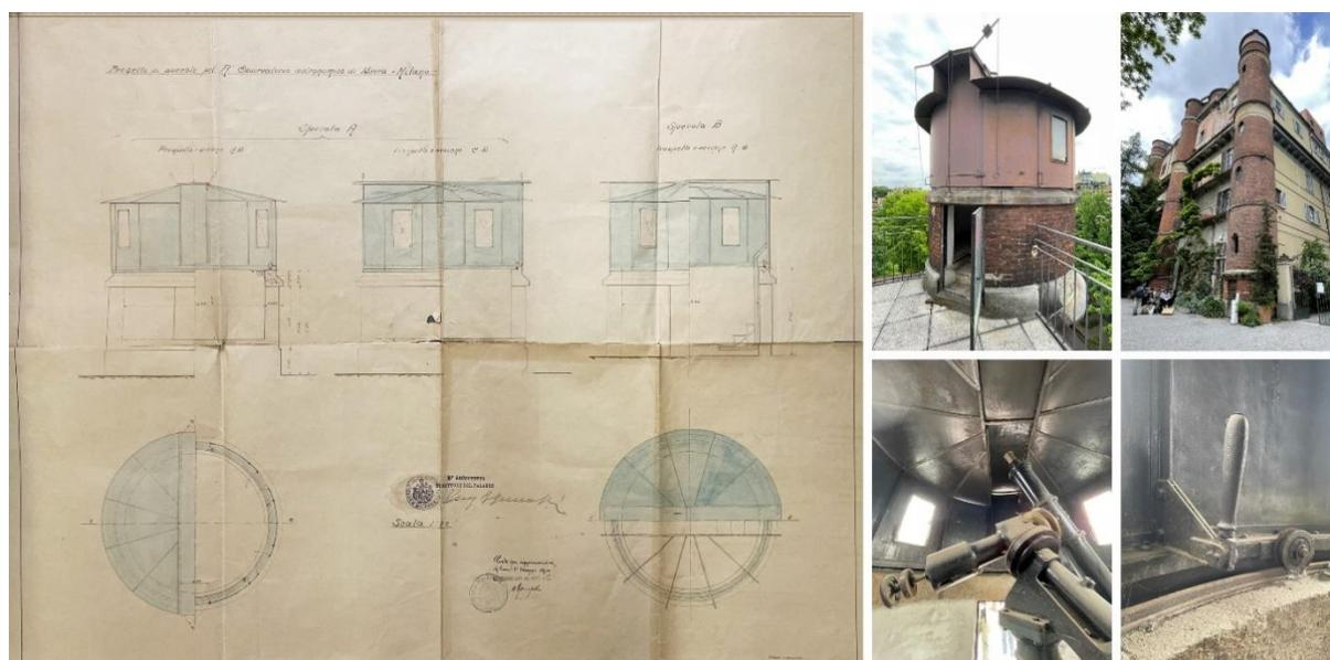
**Fig. 3.** Disegno in scala 1:20 per la specola del Regio Osservatorio Astronomico di Brera, Milano, 1919 (Archivio dell'Osservatorio Astronomico di Brera). Viste attuali e sistema di apertura (foto T. Marzi, 2023).
