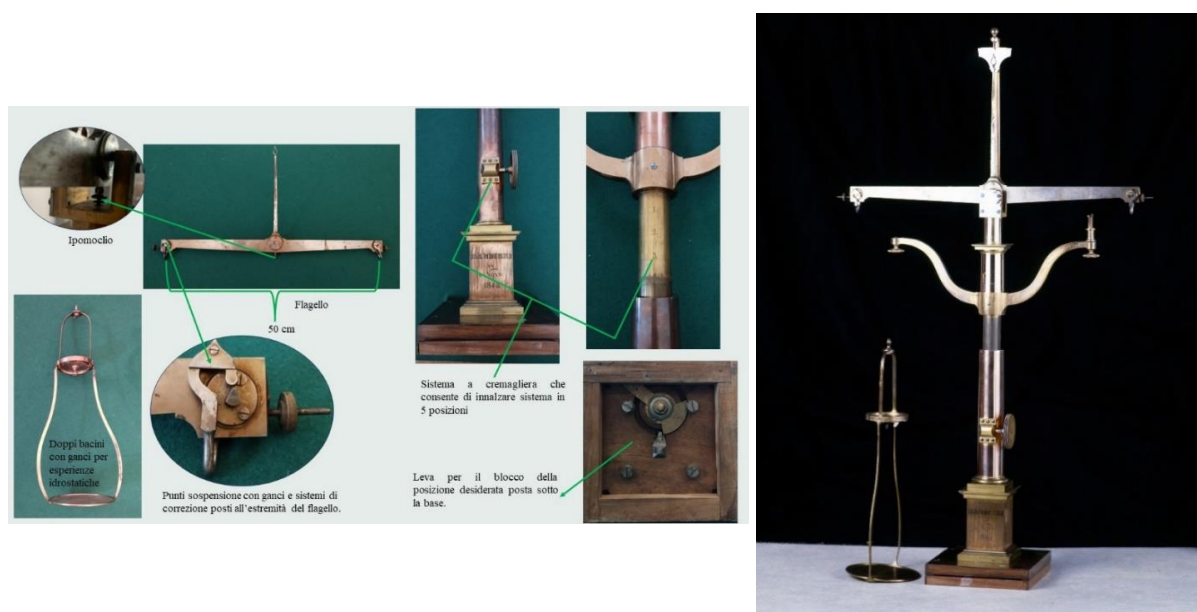
Fig. 3, sinistra. Dettaglio delle parti fondamentali della bilancia
