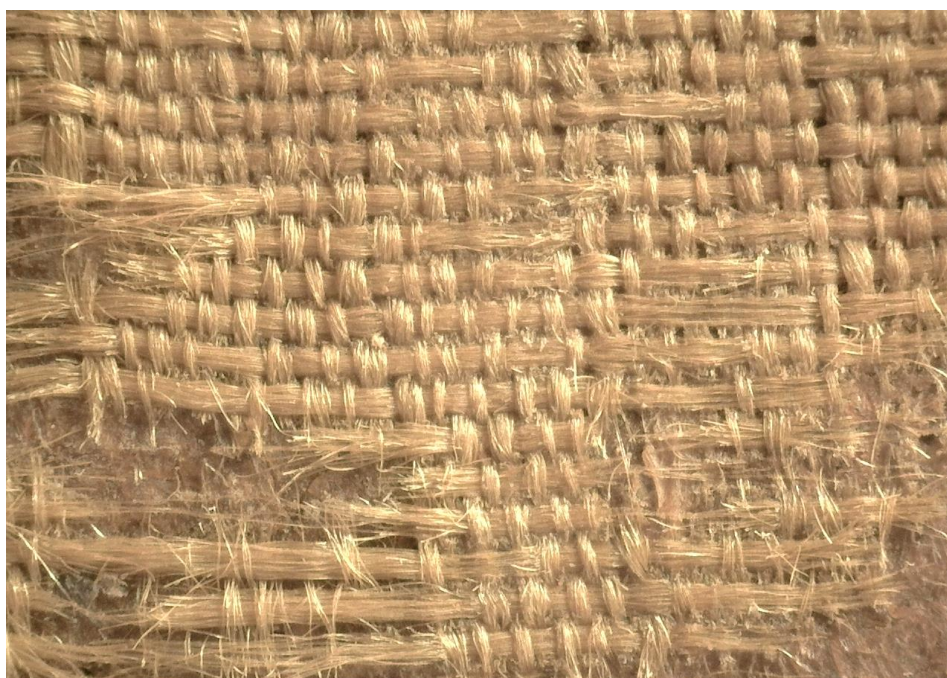
Fig. 5 – Tessuto dei contropiatti, alto ingrandimento ottenuto con microscopio Dino-Lite (MS Zanasi-Li Volsi 1)
