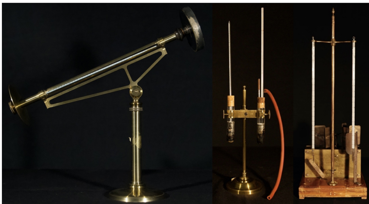
Fig. 4: Pirliometro di Pouillet, igrometro a condensazione di Regnault e psicrometro di August a ventilazione forzata a molla, in dotazione dell'Osservatorio meteorologico e oggi conservati presso la "Collezione Instrumentaria delle Scienze Fisiche" (fotografie a cura dell'Ufficio Servizi e-learning e multimediali dell'Università di Ferrara).
