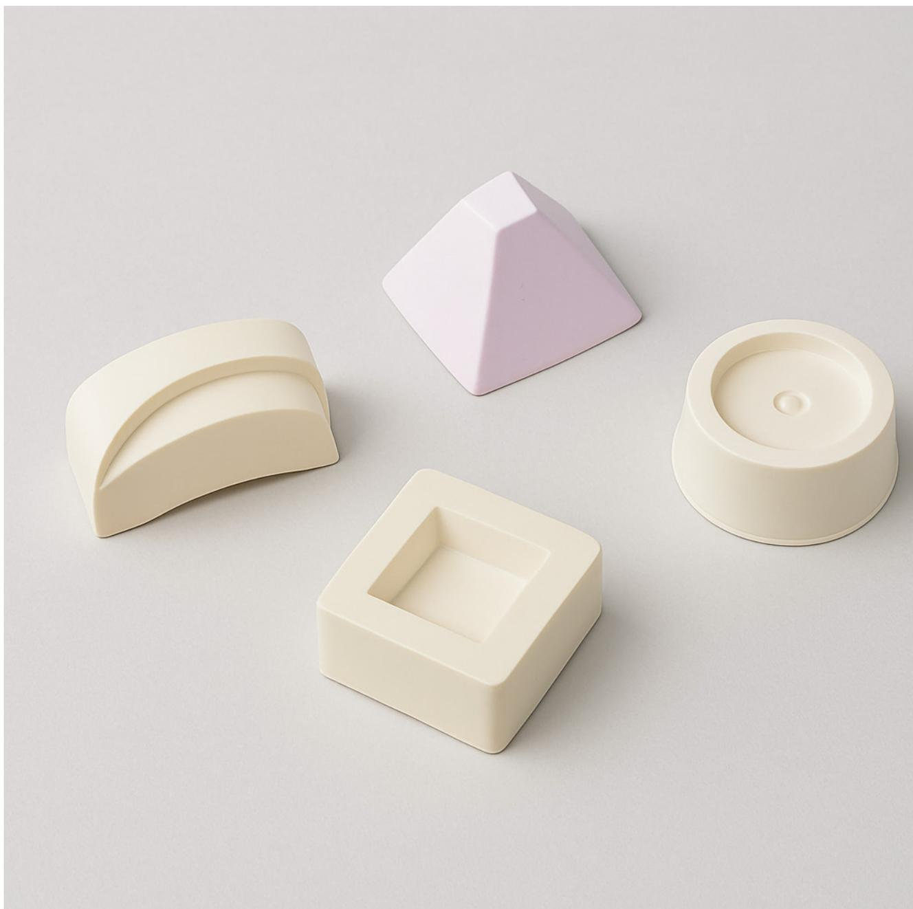
**Fig. 05** - *Campioni geometrici in geopolimero colato, realizzati tramite stampi: dimostrazione della versatilità morfologica e del potenziale estetico del materiale.* / Geometric samples in cast geopolymer, made using molds: demonstrating the morphological versatility and aesthetic potential of the material.
