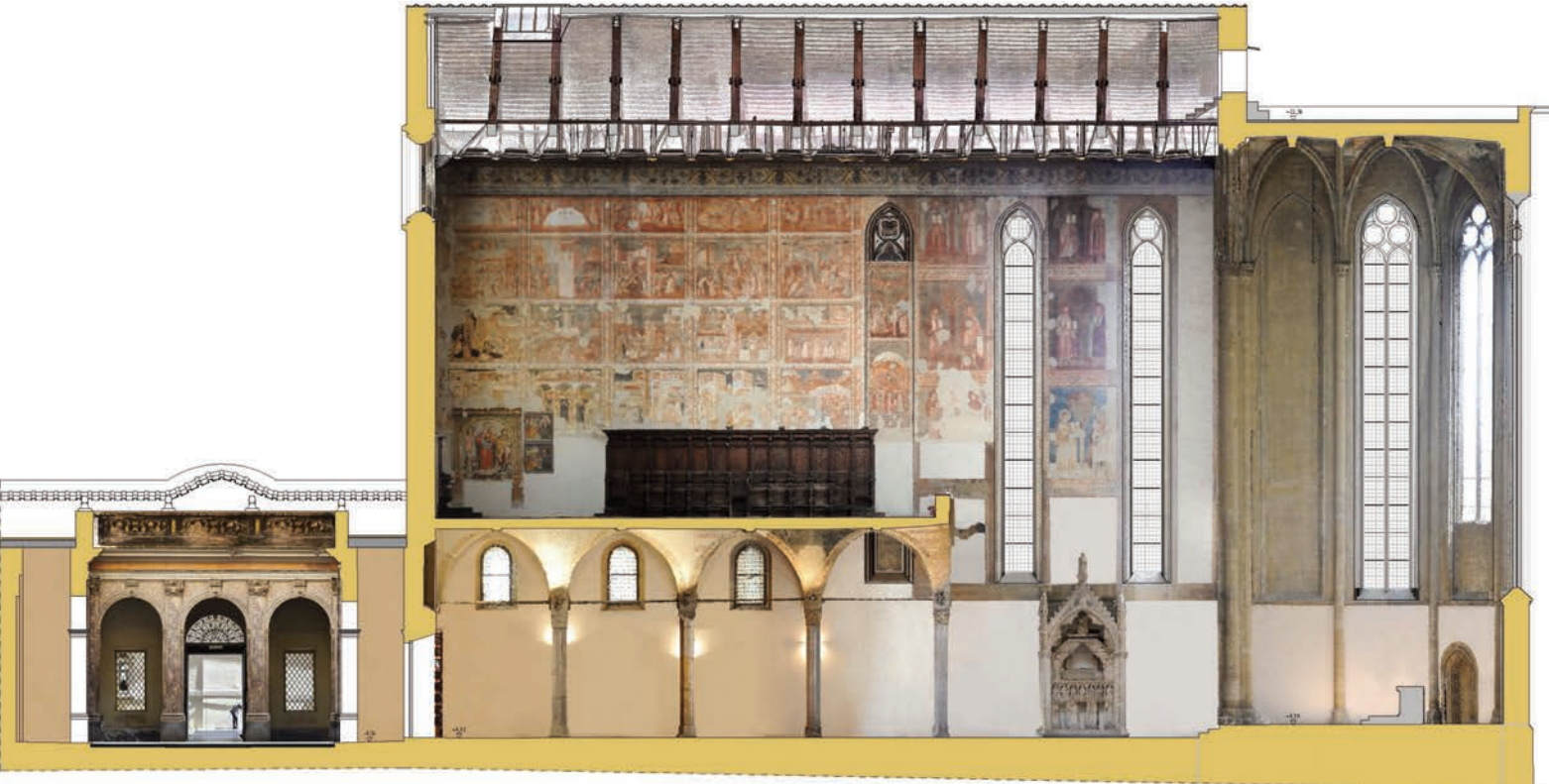
16. Sezione longitudinale della chiesa di s. Maria di Donnaregina verso la parete sinistra entrando (lato vico Donnaregina), ottenuta mediante ortoproiezione su di un piano verticale della nuvola dei punti colorata con le foto scattate dello scanner
