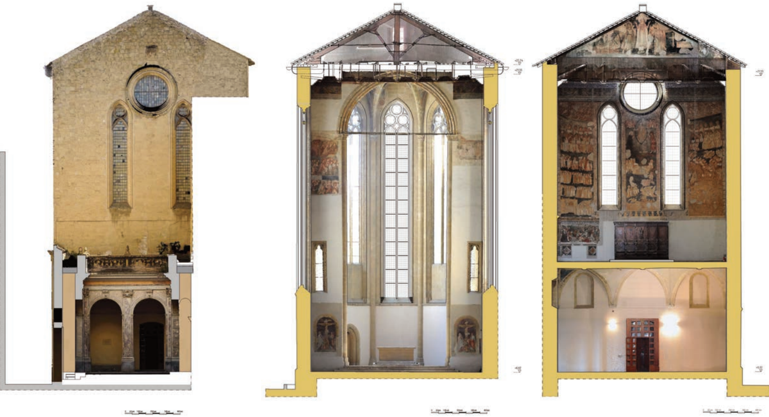
15. Sezione trasversale della chiesa di s. Maria di Donnaregina verso la parete di controfacciata, ottenuta mediante ortoproiezione su di un piano verticale della nuvola dei punti colorata con le foto scattate dello scanner
