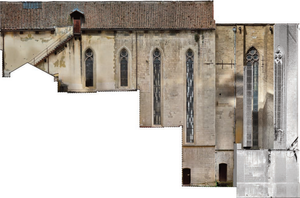
18. Prospetto lungo vico Donnaregina della chiesa di s. Maria di Donnaregina realizzato mediante fotomodellazione (integrazioni in grigio delle parti non fotografabili ottenute mediante ortoproiezione della nuvola dei punti elaborata da scanner laser)
