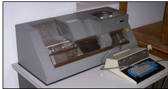
Fig. 2 - Perforatrice di schede.
