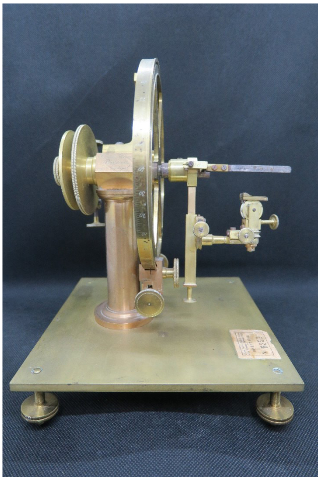
Fig. 2. Goniometro a riflessione di Arcangelo Scacchi, 1851.
