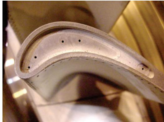
Figura 3.41. Convezione interna (primo stadio 7FA General Electric).
